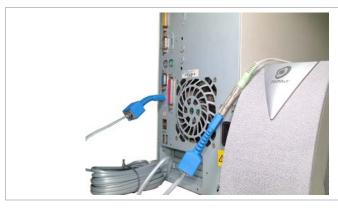
使用一條四芯線 (RJ11 4P4C) 或 Cat5eUTP 線即可有效延長 Audio(Mono.) 音源遠達 300 公尺
