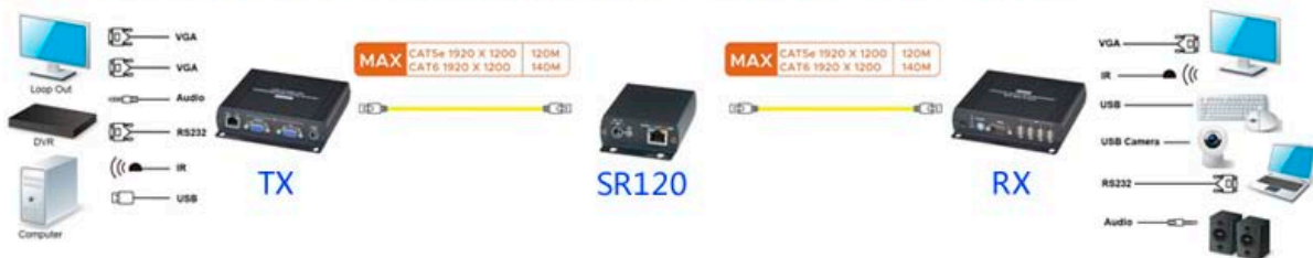
(2) 使用 CAT6 網路線搭配 SR120 延長兩端訊號各 140 米，使用 CAT5e 網路線各 120 米
