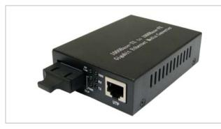
提供 1 埠 10/100/1000Base-FX 單模光纖 SC 接 頭轉換 1 埠 10/100/1000BaseRJ-45 的功能。 轉換雙絞銅線和光纖兩種不同傳輸介質,中 繼 10/100/1000Base-TX 和 1000Base-FX 兩個不 同網段,傳輸距離可達 20Km,設計符合乙太 網標準。
